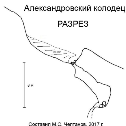
Рисунок 15. Схематичный разрез Александровского колодца
